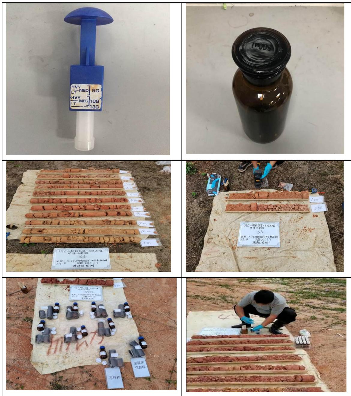
图 4.2-3 土壤样品采样仪器、贮存容器与样品采集图
